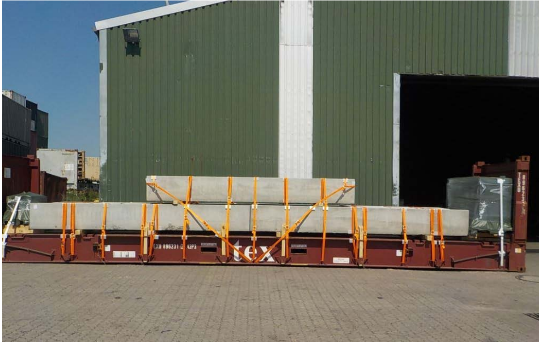
Transport über den Seeweg mit entsprechender Sicherung
